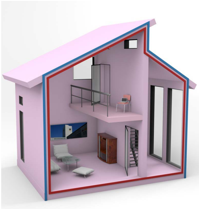
Figur 5. For å sikre optimal lufttetthet bør en tenke seg at man skal kunne trekke en kontinuerlig strek både langs dampspærren og langs vindspærren.
